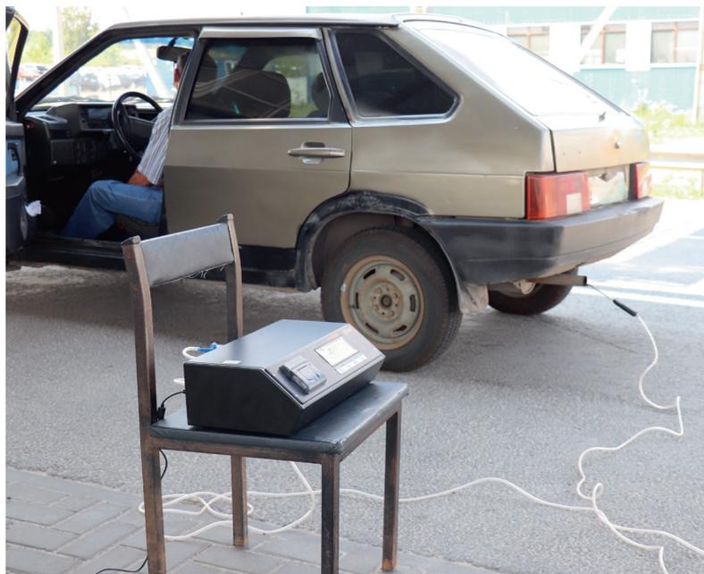
Экологи проверяют автомобили с помощью газоанализатора на предмет превышений угарного газа (СО) и углеводорода (СН). За нарушение нормативов содержания загрязняющих веществ в выбросах владельцы транспортных средств привлекаются к административной ответственности по ст. 8.23 КоАП РФ («Эксплуатация механических транспортных средств с превышением нормативов содержания загрязняющих веществ в выбросах») — штраф в 500 рублей.
