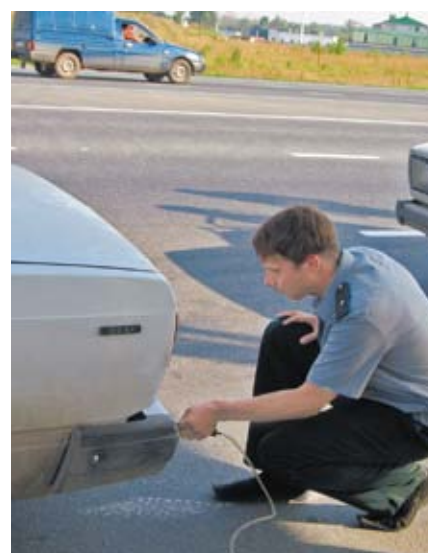
Инспектор проводит забор выхлопных газов автомобиля.
