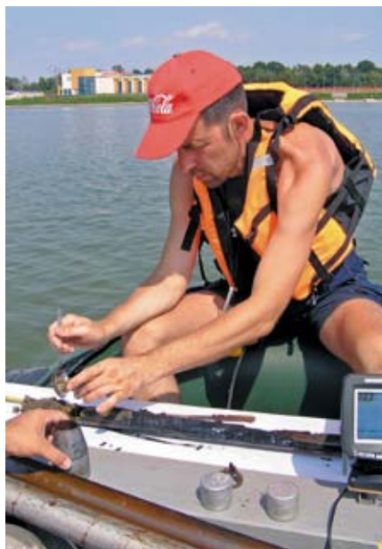
Ученые извлекают из илоотборника пробы донных отложений. После камеральной обработки невзрачные «шлепки» ила и глины позволяют оценить текущее состояние озера.
