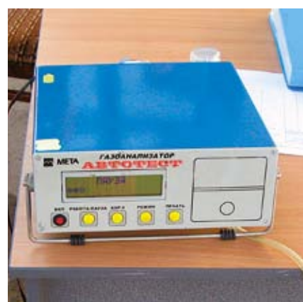
Портативный газоанализатор позволяет в течение нескольких минут оценить соответствие выхлопа нормативам.
